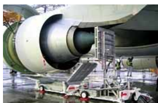
エンジン水洗による性能回復
