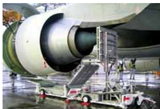
エンジン水洗による性能回復
