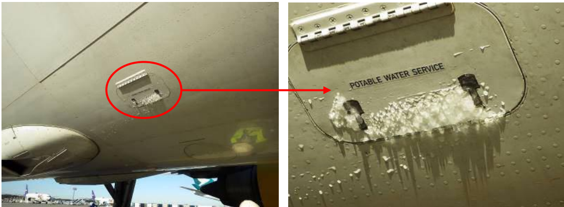
図 3-1 POTABLE WATER SERVICE パネル着氷事例
