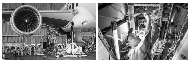
航空機整備作業の例(主脚の交換、電子装備品の交換・調整)
